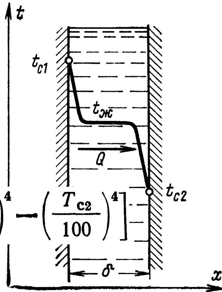
Тепловой поток, переданный путём соприкосновения, определим следующим образом:
