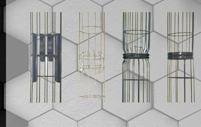
Мы поставляем фильтровальные каркасы любой длины и различных диаметров. Каркасы могут быть изготовлены как из углеродистой стали так и из нержавеющей стали, с оцинковкой или специальным покрытием, состоящим из смеси силикона и пластика, что позволяет минимизировать механический износ фильтровальных рукавов в процессе работы фильтра.
