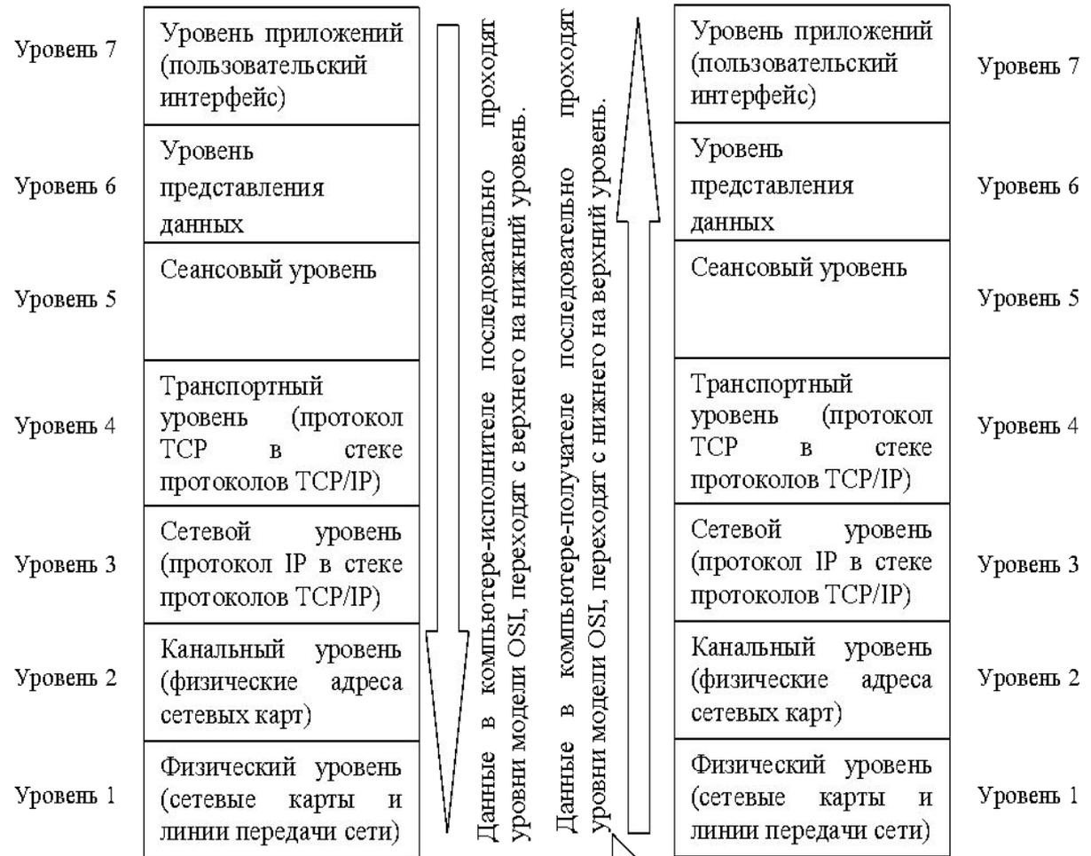
Пройдя в компьютере-отправителе программную обработку, данные поступают в линию связи
