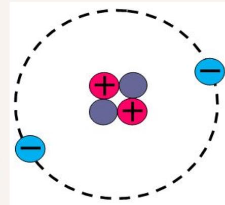
Сумма + и – зарядов в атоме равна 0, т.е. количество протонов равно количеству электронов и поэтому атомы электрически нейтральны.
