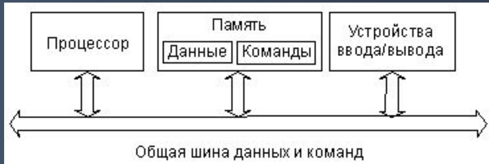
Рис. 1.4. Архитектура с общей шиной данных и команд.
