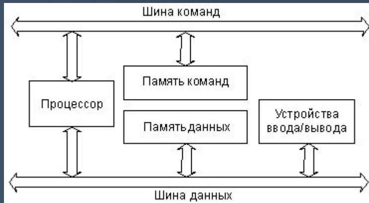
Рис. 1.5. Архитектура с отдельными шинами данных и команд
