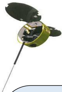
Микроспутник TacSat-1 (США) Масса .....120 кг
