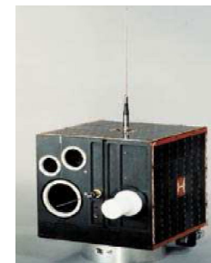
Германский микроспутник DRL-Tubsat Масса .....45 кг Разрешение ... 6 м
