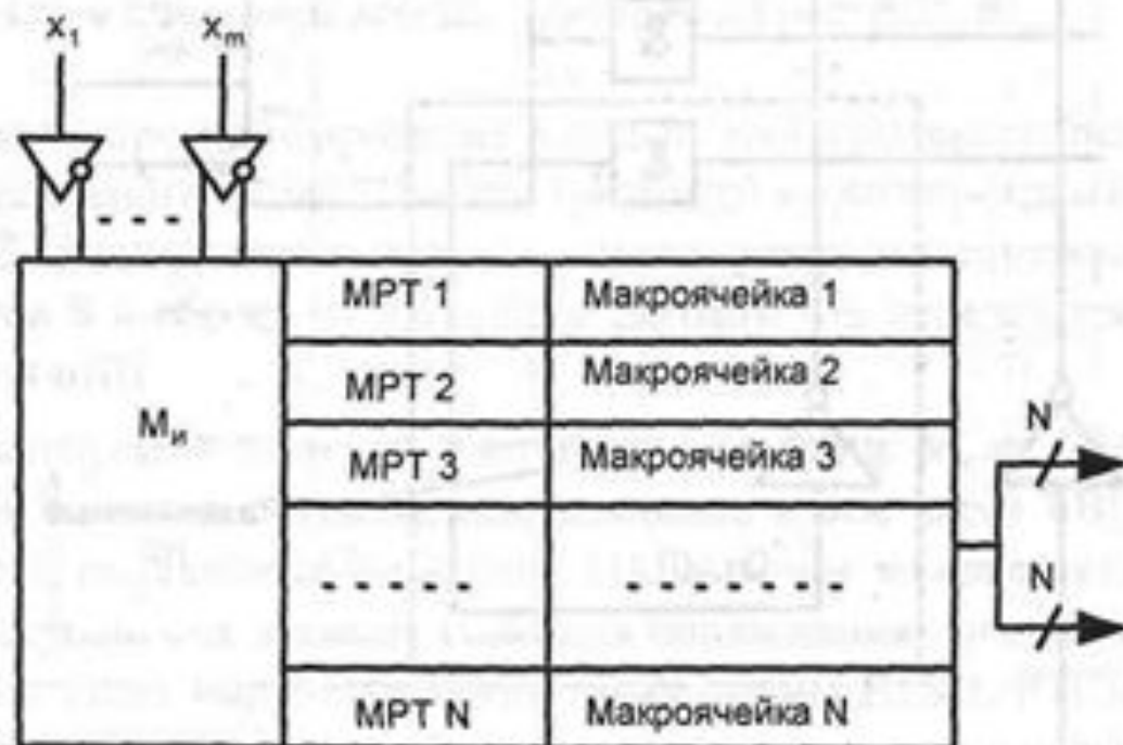
Обобщенная структура функционального блока CPLD
