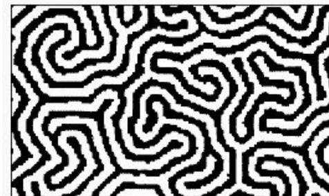
Лабиринтная магнитная доменная структура на поверхности пластины, перпендикулярной оси лёгкого намагничивания.
