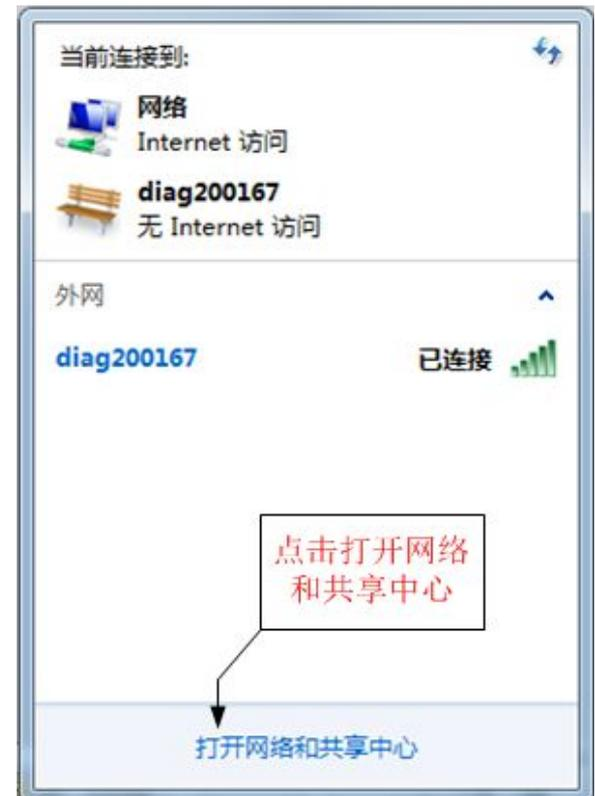
鼠标右键点击与智多星SSID同名的网络，选择属性(右图)，在弹出的“无线网络连接 状态”界面(下图)中点击属性。
