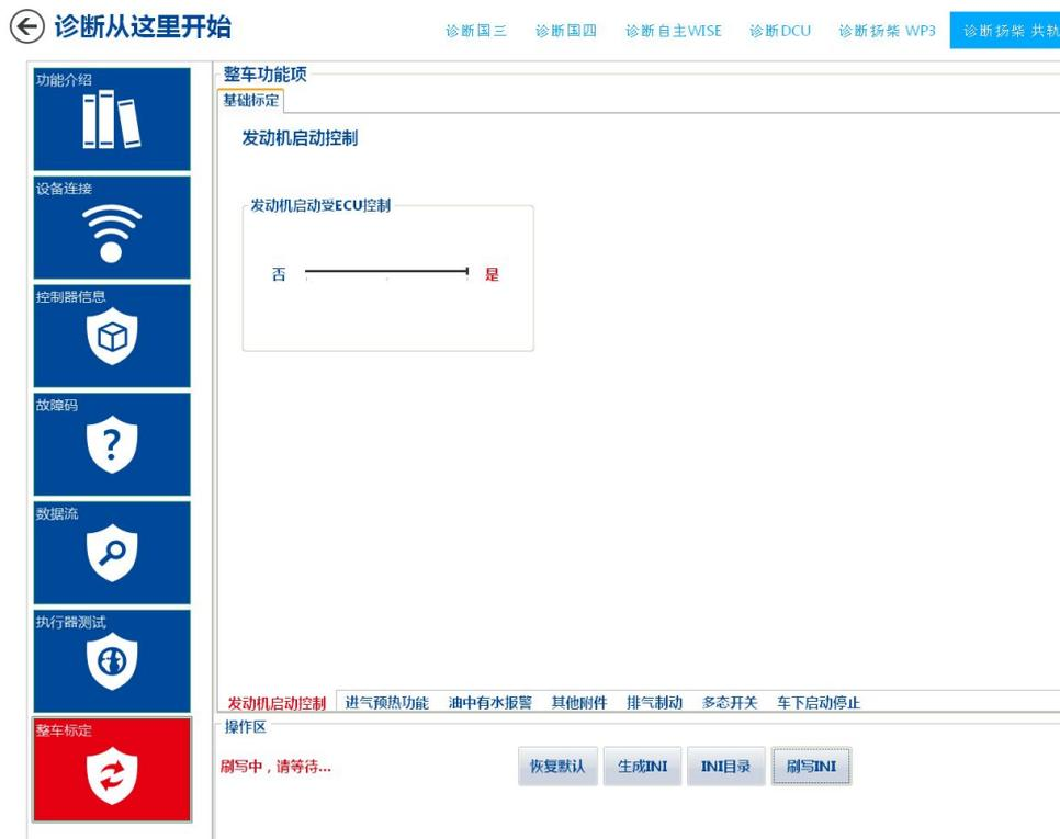
检测条件：T15上电；发动机转速为0
