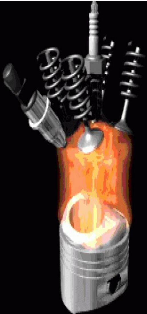
**Детонационное сгорание в цилиндре двигателя** представляет собой сгорание последних частей заряда в результате его объемного самовоспламенения. Оно сопровождается возникновением ударных волн, скорость которых может в десятки раз превышать скорость распространения фронта турбулентного пламени и достигать 1500 м/с.
