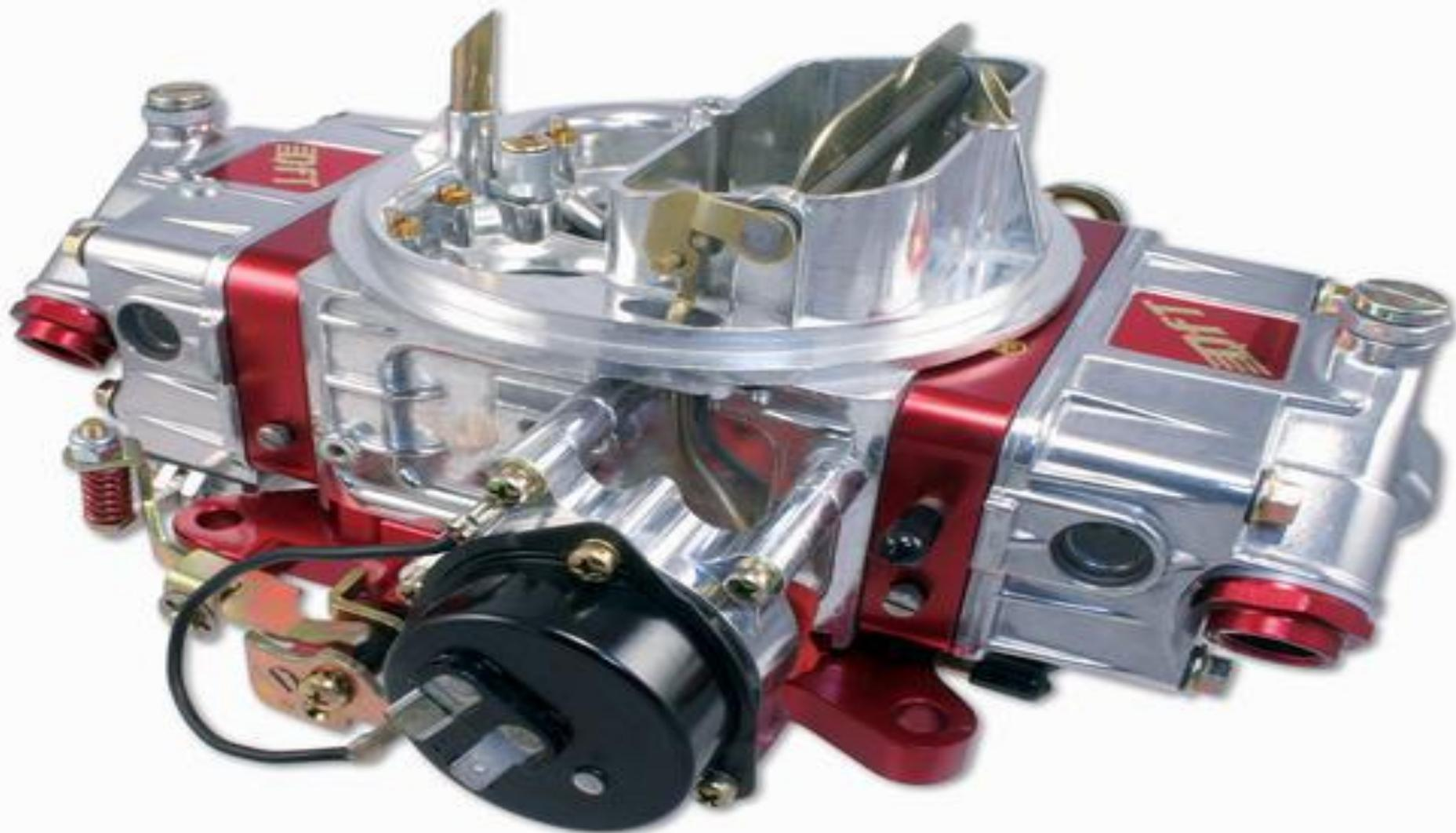
Смеседозирующие устройства карбюратора обеспечивают необходимое соотношение между распыленным топливом и воздухом на каждом режиме (пуск, холостой ход, средние обороты, высокие обороты, максимальные обороты). Полученная таким образом смесь мельчайших частиц и паров бензина с воздухом называется *горючей смесью*
