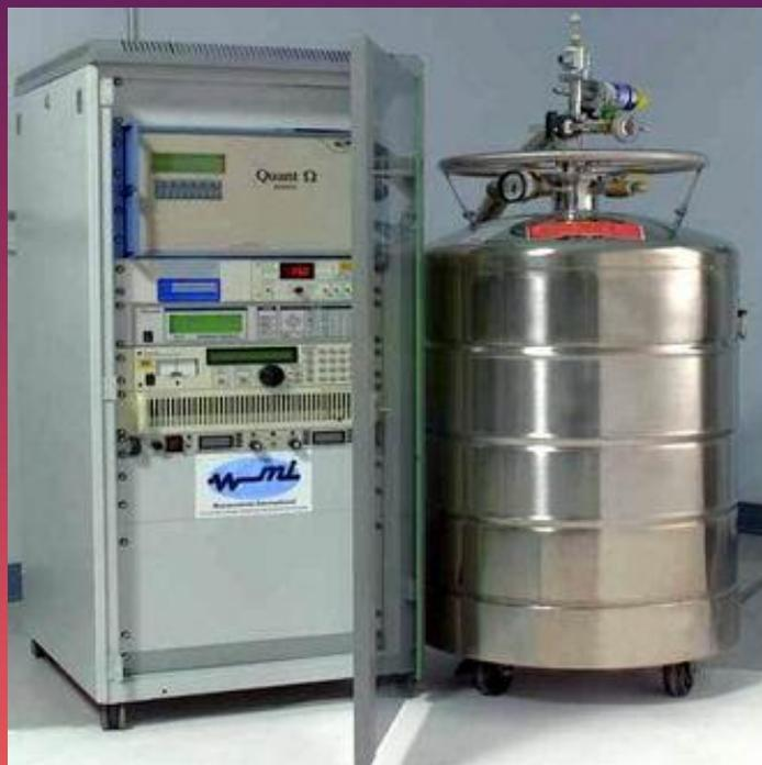
QUANTΩ – автоматизированная, переносная система первичного сопротивления, которая представляет собой экономичное средство для точного переноса сопротивления устройства на основе квантового сопротивления Холла ( $I=2$ ) на вторичные эталоны сопротивления. Переносит сопротивление устройства на основе квантового сопротивления Холла на стандартный резистор сопротивлением  $1000\Omega$  с точностью  $<0,02$  ppm и повторением  $<0,01$  ppm.
