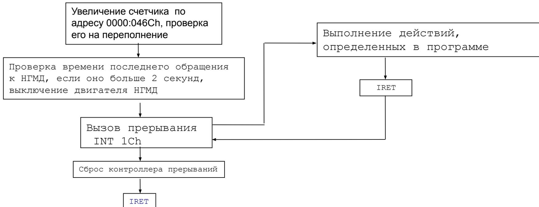
механизм обработки прерывания таймера
