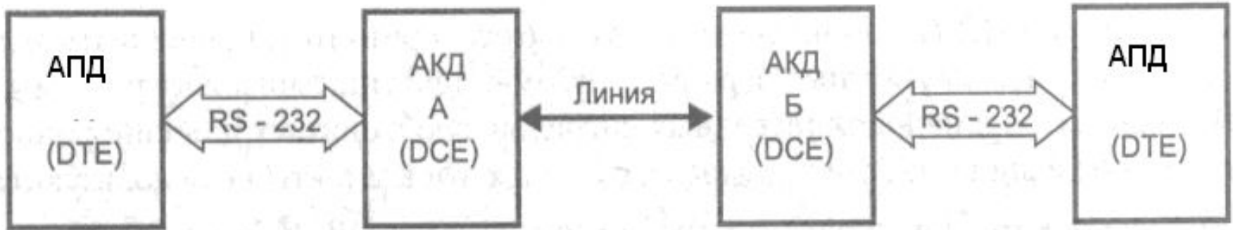
Рис.2 Полная схема соединения по RS-232C
