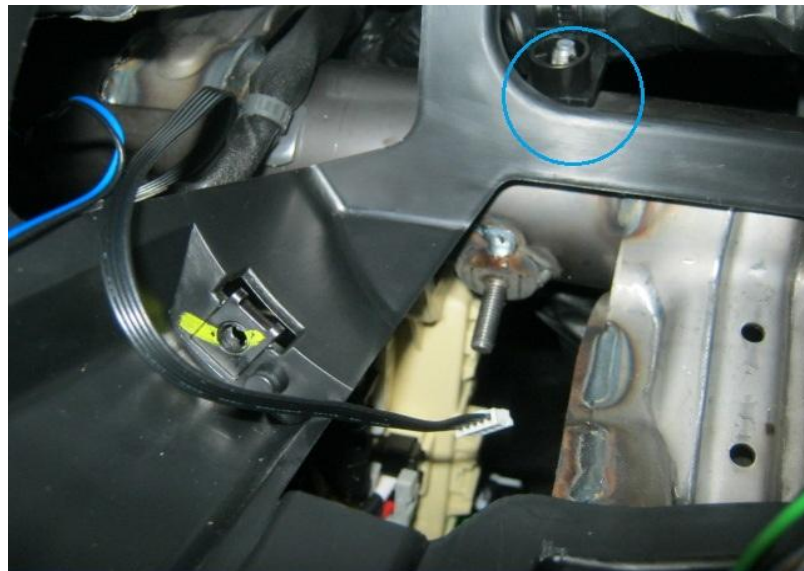
Фото 8. Масса (пластиковое крепление жгута снять)
