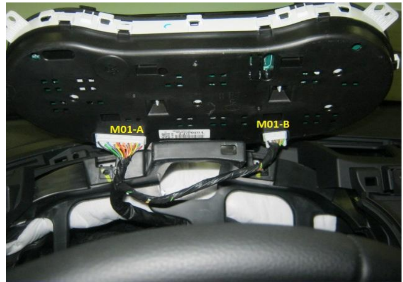
Фото 3.6. Разъёмы приборного щитка
