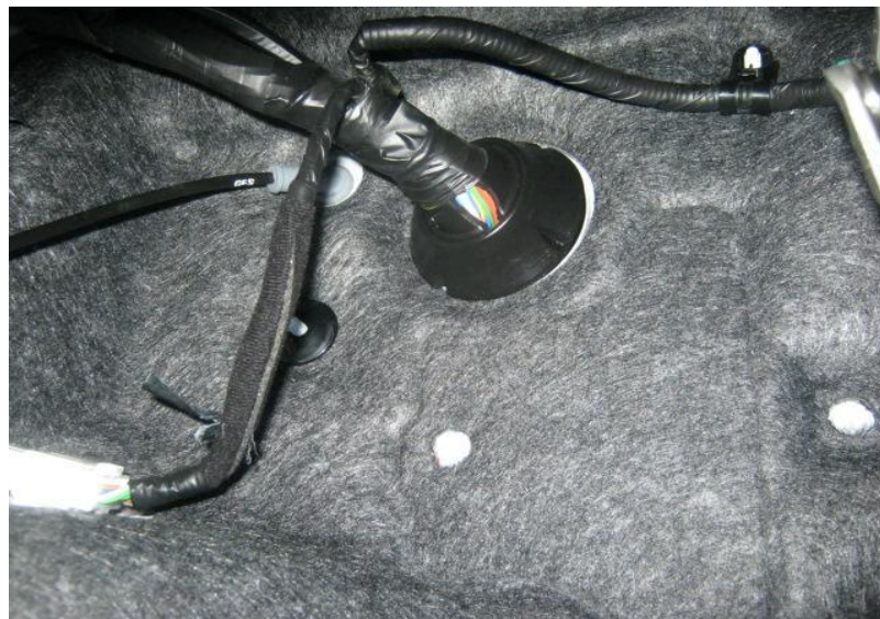
Фото 5.6. Штатный уплотнитель(вид со стороны салона)
