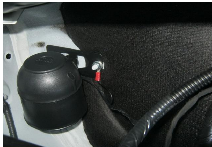
Фото 5.2. Сирена. Крепление гайкой М6
