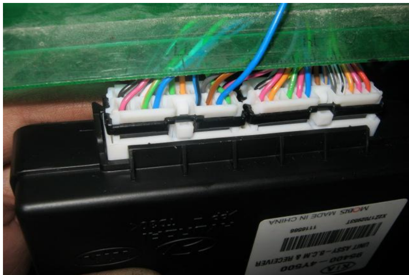
Фото 13.3. Генератор (Синий, №2 разъёма M04-B)
