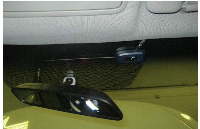
Фото 4.2. Антенна на лобовом стекле
