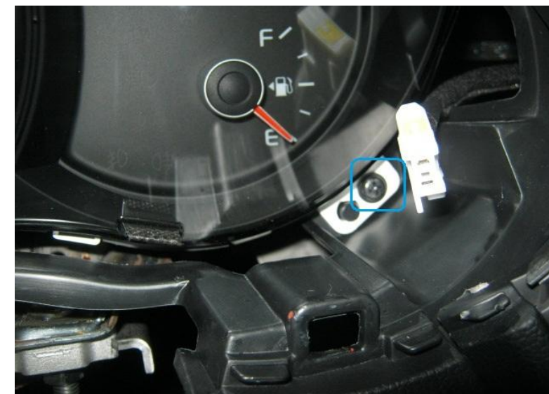
Фото 3.4. Крепление приборного щитка
