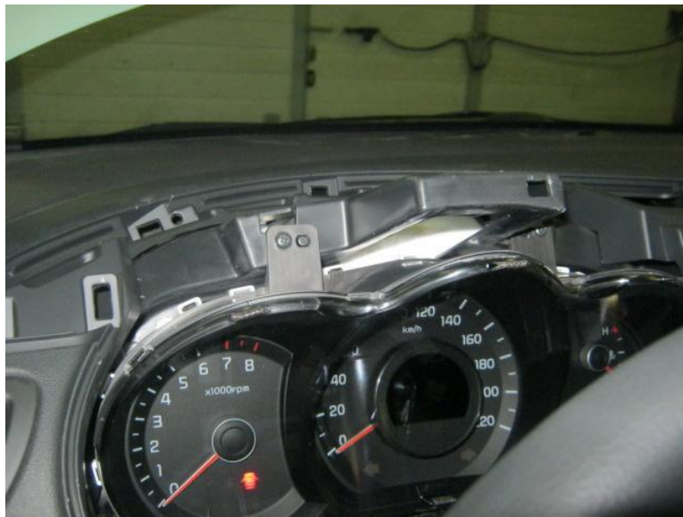
Фото 3.1. Снятие облицовки приборного щитка
