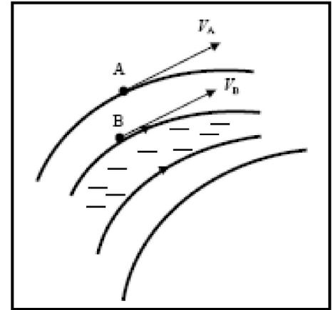
Турбулентное течение – это вихревое течение жидкости сопровождающееся перемешиванием слоев, обусловленным образованием вихрей. Скорость частиц непрерывно меняется.
