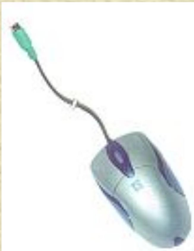
**Мышь** имеет вид небольшой коробки, полностью уместящейся на ладони. Мышь связана с компьютером кабелем через специальный блок — адаптер, и её движения преобразуются в соответствующие перемещения курсора по экрану дисплея. При перемещении «мыши», **курсор** на экране монитора перемещается в том же направлении и с аналогичной скоростью.
