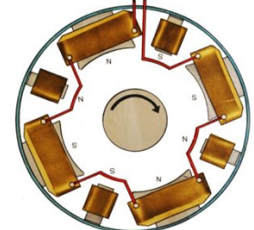
Схема соединения катушек добавочных полюсов генератора
