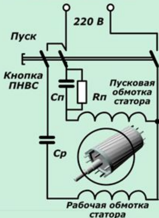
Схема подключения двигателя с рабочим и пусковым конденсаторами
