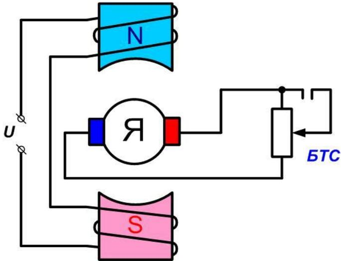
Обмотки якорей всех ТЭД подключаются к БТС (блоки тормозных сопротивлений). Обмотки возбуждения получают питание от обмоток тягового трансформатора через выпрямительную установку.
