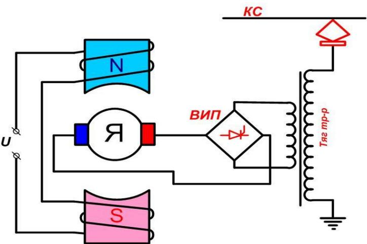
Для осуществления данного вида торможения необходимо, чтобы напряжение вырабатываемое ТЭД в режиме генератора было выше напряжения контактной сети, для этого необходимо чтобы на участке находился потребитель т.е электровоз идущий на подъем или ПС. В противном случае: На электровозе переменного тока произойдет «опрокидывание» инвертора, а на электровозе постоянного тока двигатели перейдут в режим контртока.
