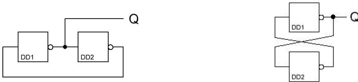
Рисунок 5 - Триггер это простейшая последовательностная схема
