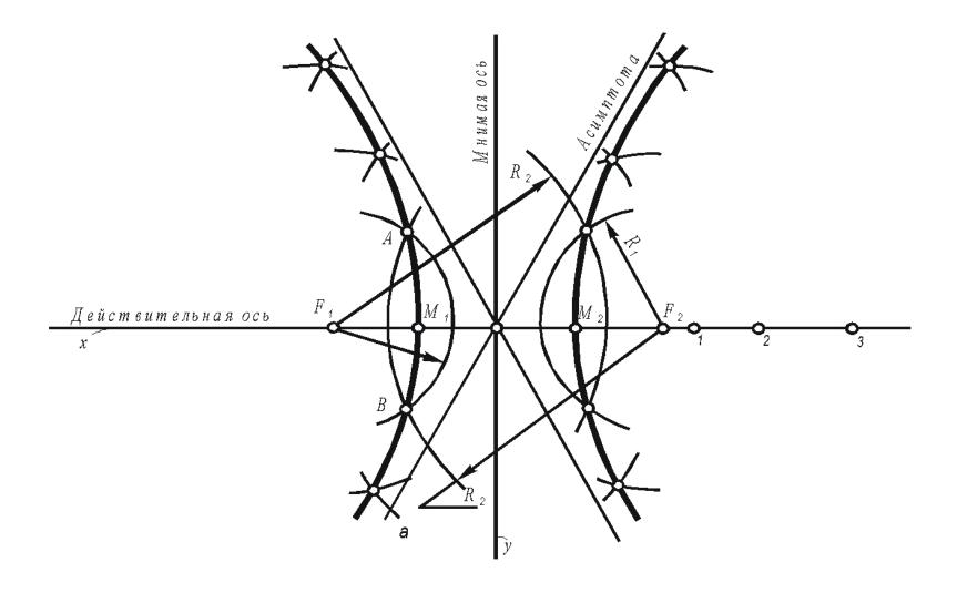
Построение кривой второго порядка по трем точкам и двум касательным
