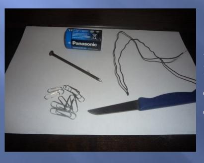
Я взяла гвоздь, батарейку, провод, несколько металлических скрепок для проведения опытов и ножик для оголения проводов.
