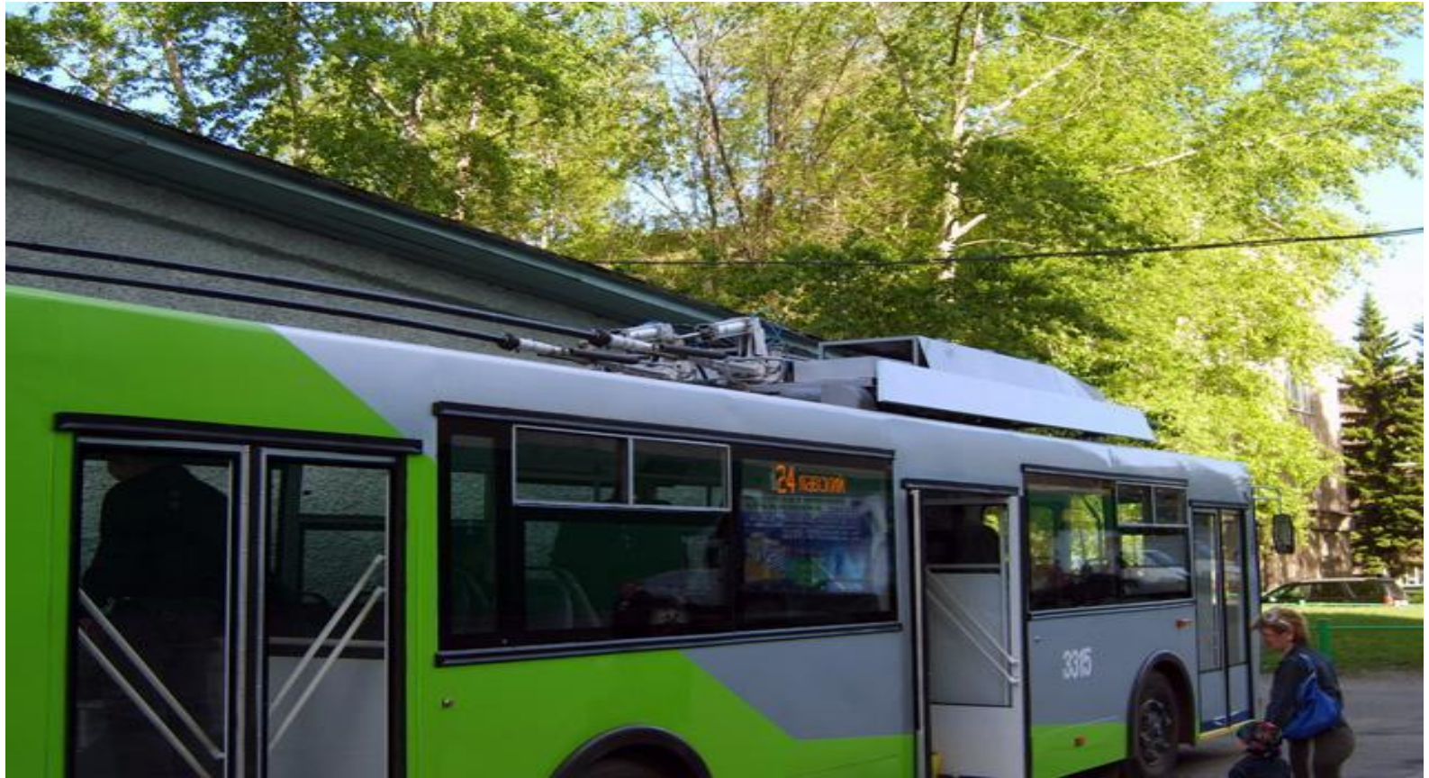
Рис. 8. Размещение электрооборудования на крыше троллейбуса
