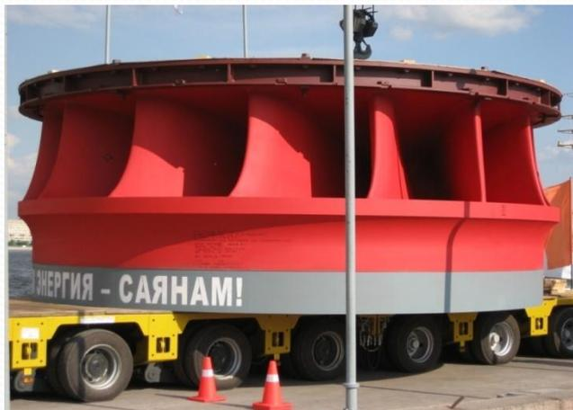
Рабочее колесо радиально-осевой гидротурбины
