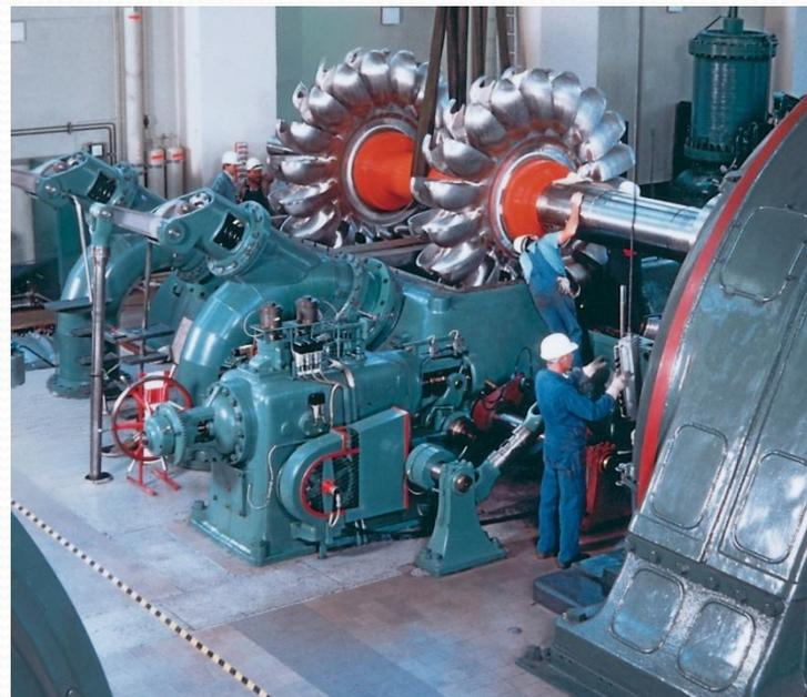
Ковшовая гидротурбина с горизонтальным расположением вала.
