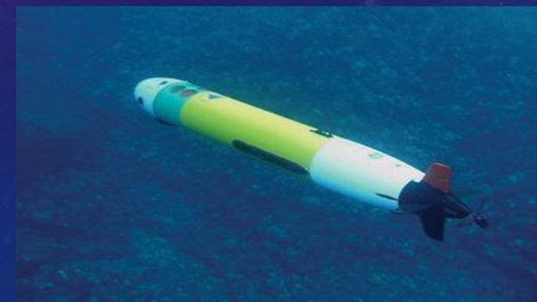
Подводный робот REMUS 100 (Hydroid) создано 200 экз.
