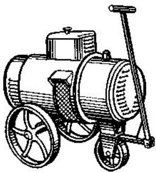
Рис. 2.19 – Сварочный преобразователь ПСО-500
