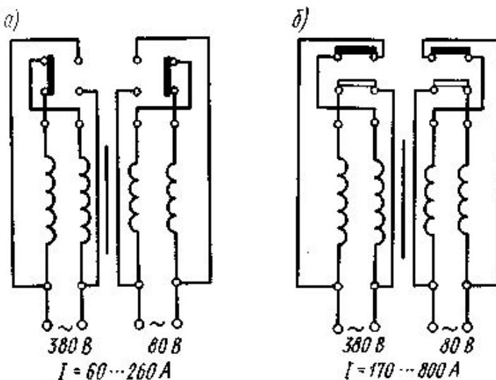
Рис. 2.33 – Схема аппарата СТШ-500-80: а – последовательное соединение обмоток для малых сварочных токов; б - параллельное соединение обмоток для больших сварочных токов
