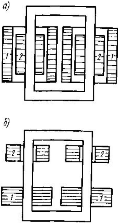
Рис. 2.30 – Сварочные аппараты с увеличенным рассеянием: а – обычный силовой трансформатор; б – трансформатор с увеличенным магнитным рассеянием
