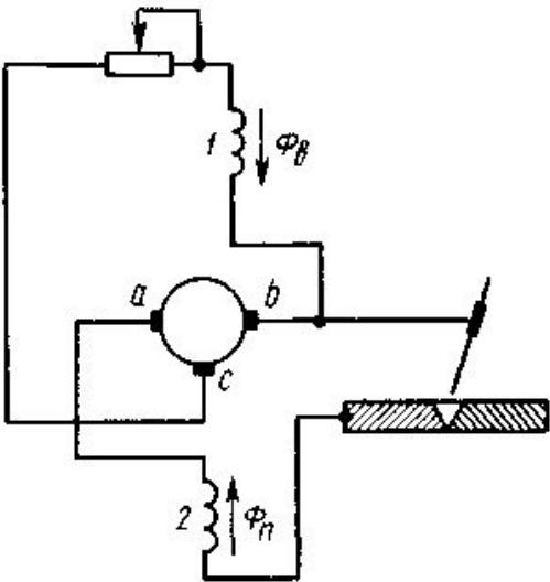
Рис. 2.18 – Генератор с размагничивающим действием последовательной обмотки возбуждения
