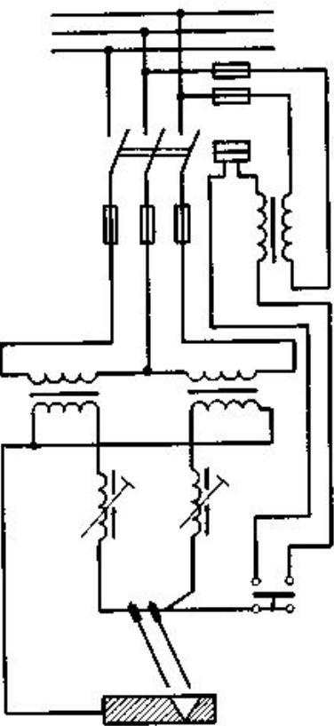
Рис. 2.35 – Схема питания трехфазной сварочной дуги
