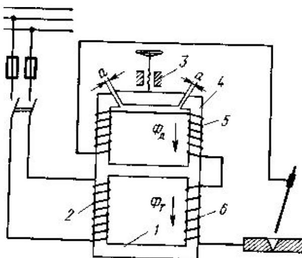
Рис. 2.28 – Схема сварочного аппарата переменного тока со встроенным дросселием: 1 – основной магнитопровод; 2 – первичная обмотка; 3 – винтовой механизм; 4 – добавочный магнитопровод; 5 – обмотка дросселя; 6 – вторичная обмотка
