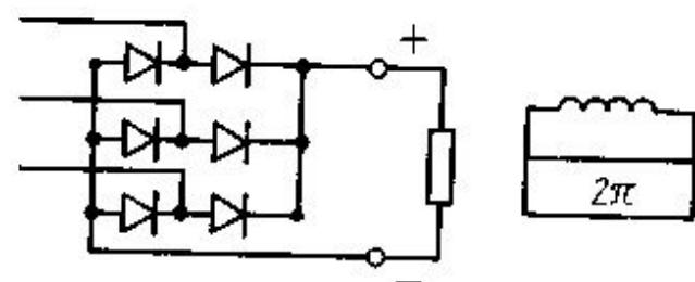
Рис. 2.38 – Схема выпрямительного блока
