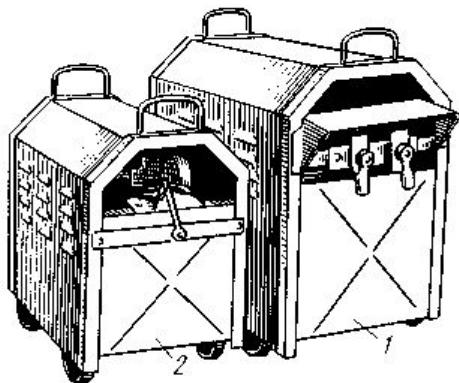
Рис. 2.27 – Трансформатор СТЭ-34-У с регулятором типа РСТЭ-34:
