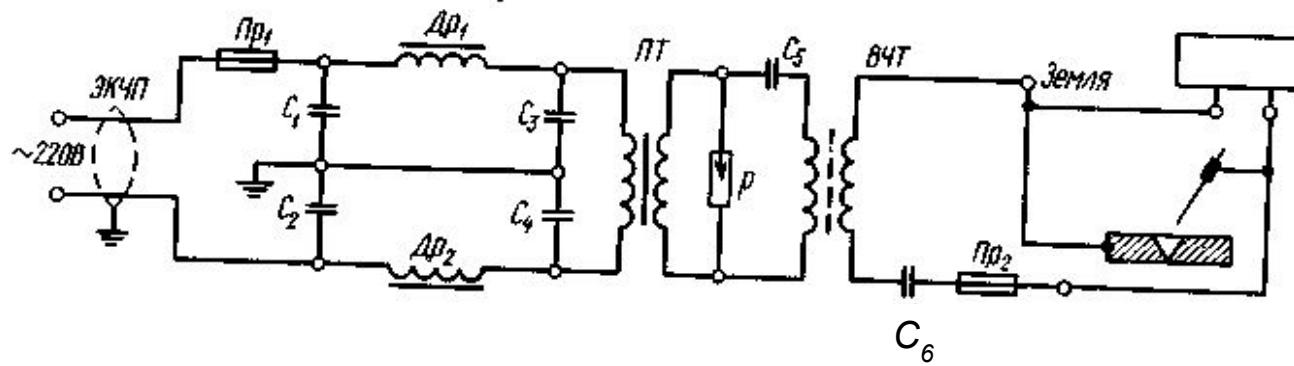
Осцилляторы последовательного включения (М-3, ОС-1) применяют в установках для дуговой сварки в защитных газах. Они обеспечивают более надежную защиту генератора (или силового выпрямительного блока) от пробоя высокочастотным напряжением осциллятора.
