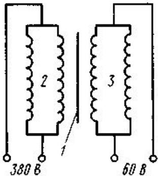
Рис. 2.32 – Схема сварочного аппарата с увеличенным магнитным рассеянием и подвижным магнитным шунтом: 1 – магнитный шунт; 2 – первичная обмотка; 3 – вторичная обмотка
