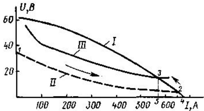
Рис. 2.15 – Зависимость между напряжением и током на клеммах сварочной цепи генератора
