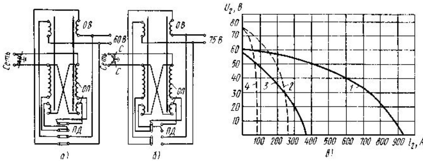
Рис. 2.30 – Схема работы трансформатора типа ТД: а – схема включения большого сварочного тока – при параллельных соединениях катушек первичной и вторичной обмоток; б - схема включения малого сварочного тока – при последовательных соединениях катушек первичной и вторичной обмоток; в – внешняя вольт-амперная характеристика трансформатора ТД; 1, 3 – диапазон больших токов; 2, 4 – диапазон малых токов
