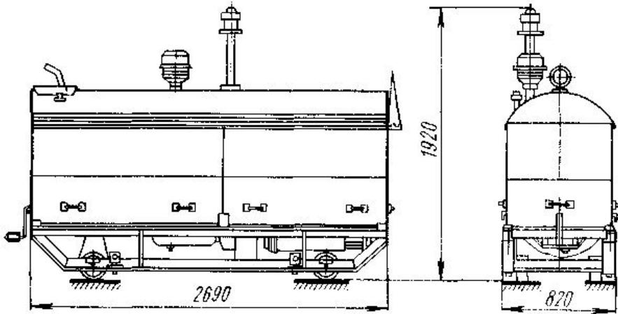
Рис. 2.20 - сварочный агрегат типа ПАС-400-VIII.
