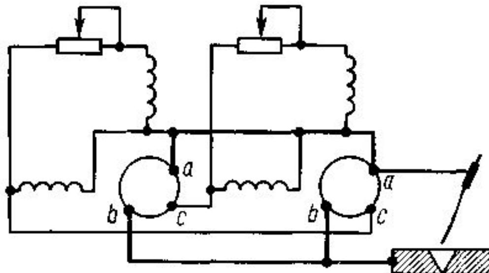
Рис. 2.25 – Схема уравнивания напряжения параллельно работающих генераторов
