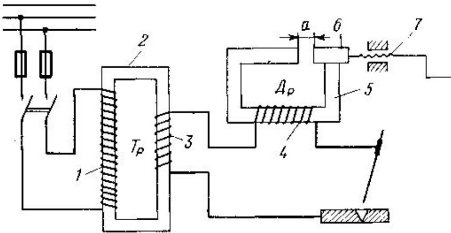
Рис. 2.26 – Сварочный аппарат переменного тока с отдельным дросселем: 1 – первичная обмотка; 2 – магнитопровод; 3 = вторичная обмотка; 4 – обмотка дросселя (регулятора тока); 5 – неподвижная обмотка дросселя; 6 – подвижная обмотка дросселя; 7 – винтовая пара
