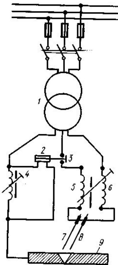
Третья обмотка 4 расположена на втором магнитопроводе и подключена к свариваемой детали 9. Регулятор вмонтирован в общий корпус и снабжен двумя рукоятками, с помощью которых производится регулирование сварочного тока (изменением воздушных зазоров в магнитопроводах). Одной рукояткой регулируют ток одновременно в обеих фазах, подключенных к электродам, а второй рукояткой — в фазе свариваемого изделия.
