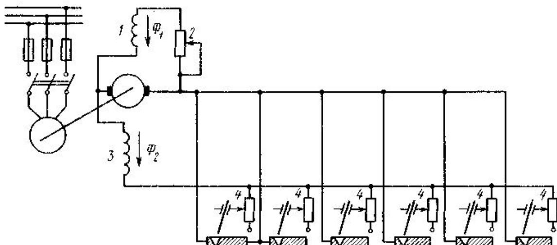
Рис. 2.22 – Схема многопостового сварочного генератора: 1, 3 – обмотка возбуждения магнитного потока  $\Phi_1$  и  $\Phi_2$  соответственно; 2 – реостат; 4 – балластные реостаты
