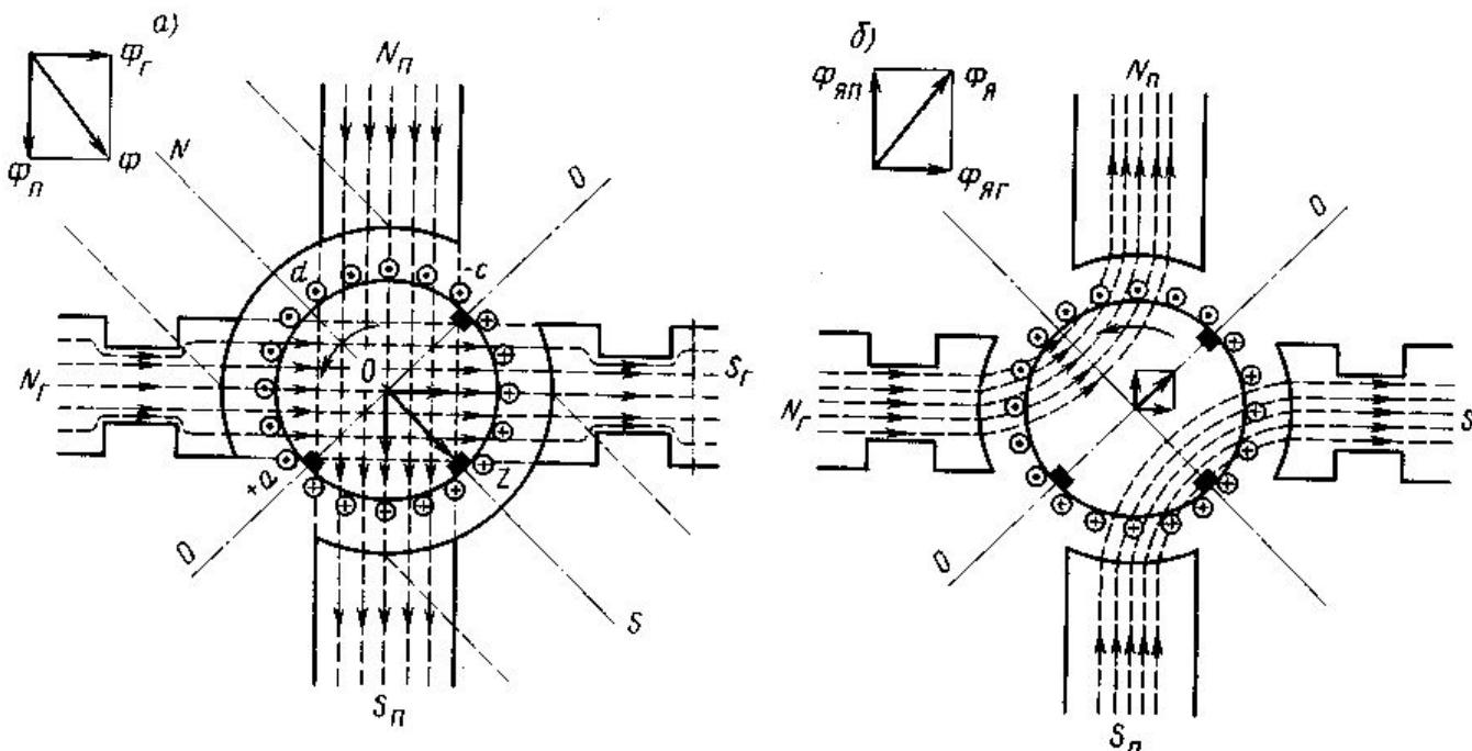
Рис. 2.16 – Схема работы генератора с расщепленными полюсами:
