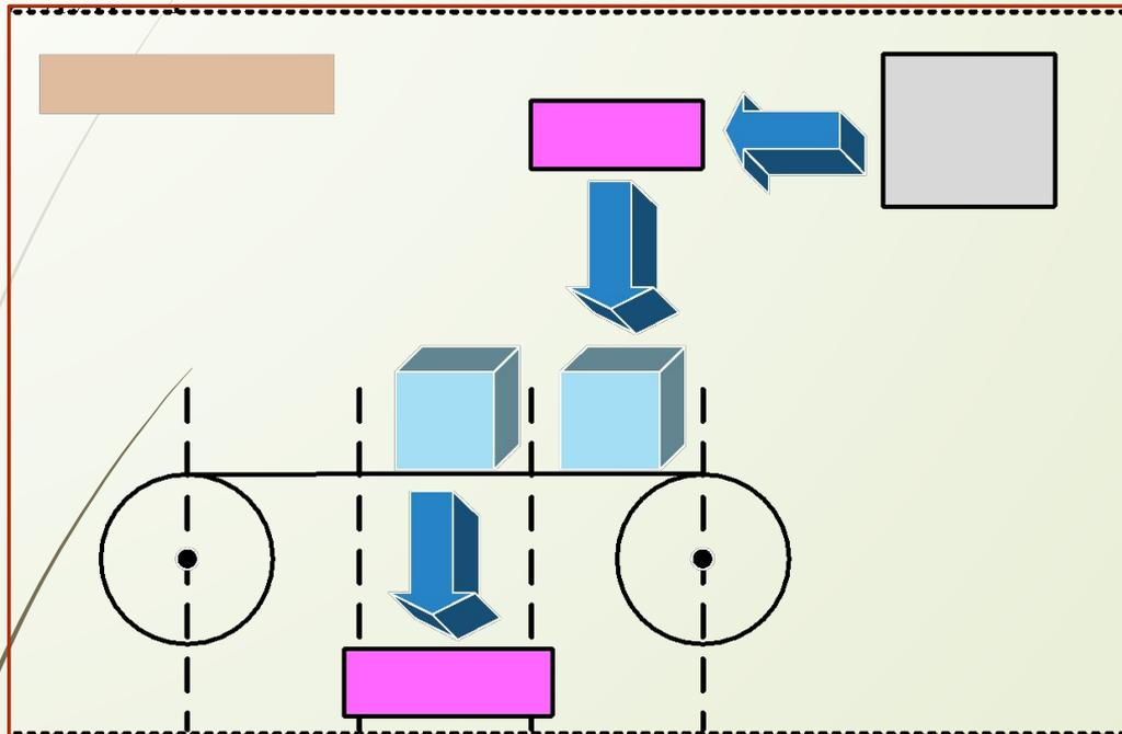
*2 такт – декодировать* код операции уже находящейся на конвейере команды - определить, что же должен делать операционный блок процессора, какая микропрограмма обработки данных должна быть запущена.
