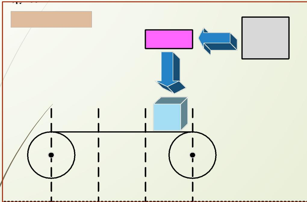
*1 такт – выбрать команду* из памяти по интерфейсу «Процессор» - «Кодовая память». Обработчик этого каскад извлекает очередную команду из памяти и размещает ее на конвейере – *загружает конвейер* новой командой.
