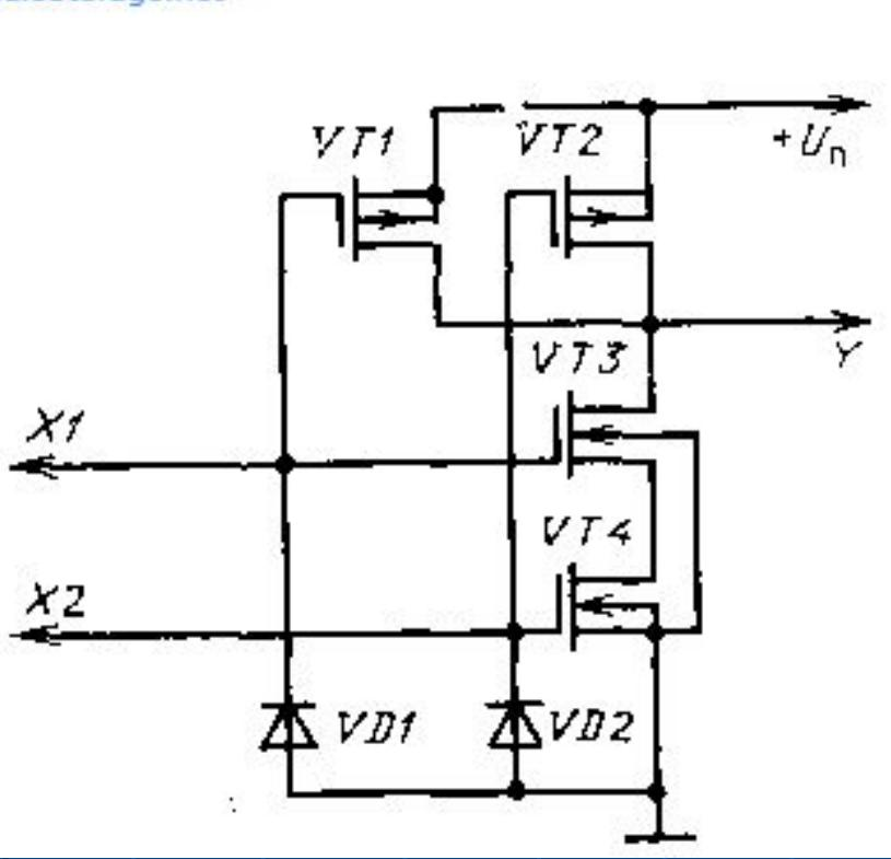
В логическом элементе (рис. 5), выполняющем функцию И-НЕ, работают комплементарные полевые транзисторы. Транзисторы с каналом р-типа (VT1, VT2) подключены к положительному проводнику источника питания, а с каналом N-типа (VT3, VT4) соединены последовательно. Передаточная характеристика элемента приведена на рис. 6. При входном напряжении 2 В и менее транзисторы VT1 и VT2 открыты, так как напряжение на участках затвор — исток (при напряжении питания 9 В) составляет не менее 7 В.
