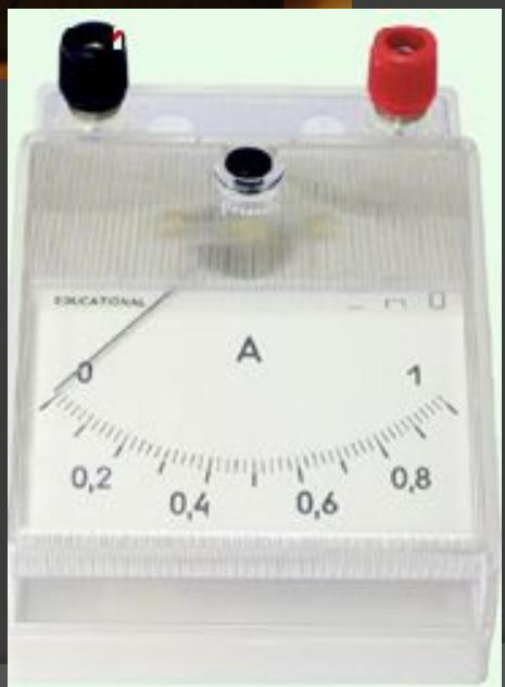
**Амперметр** - прибор для измерения силы тока в амперах. В электрическую цепь амперметр включается последовательно с тем участком электрической цепи, силу тока в котором измеряют; для увеличения предела измерений - с шунтом или через трансформатор. Амперметры бывают магнитоэлектрическими, электромагнитными, электродинамическими, тепловыми, индукционными, детекторными, термоэлектрическими и фотоэлектрическими.
