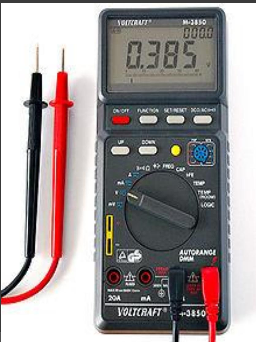
**Мультиметр** - измерительный прибор, объединяющий в себе несколько функций. В минимальном наборе это вольтметр, амперметр и омметр. Существуют цифровые и аналоговые мультиметры.
