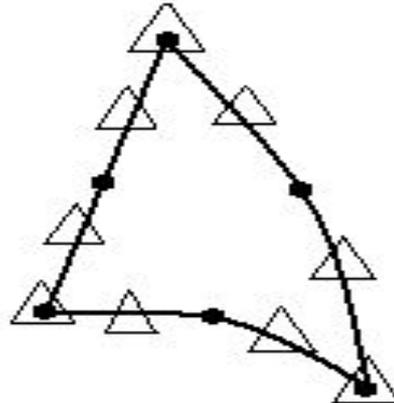
$\Delta$  - функции формы геометрии
