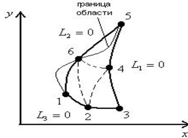
Если функции формы для аппроксимации геометрии и неизвестных совпадают, то конечный элемент называется **изопараметрическим**.
