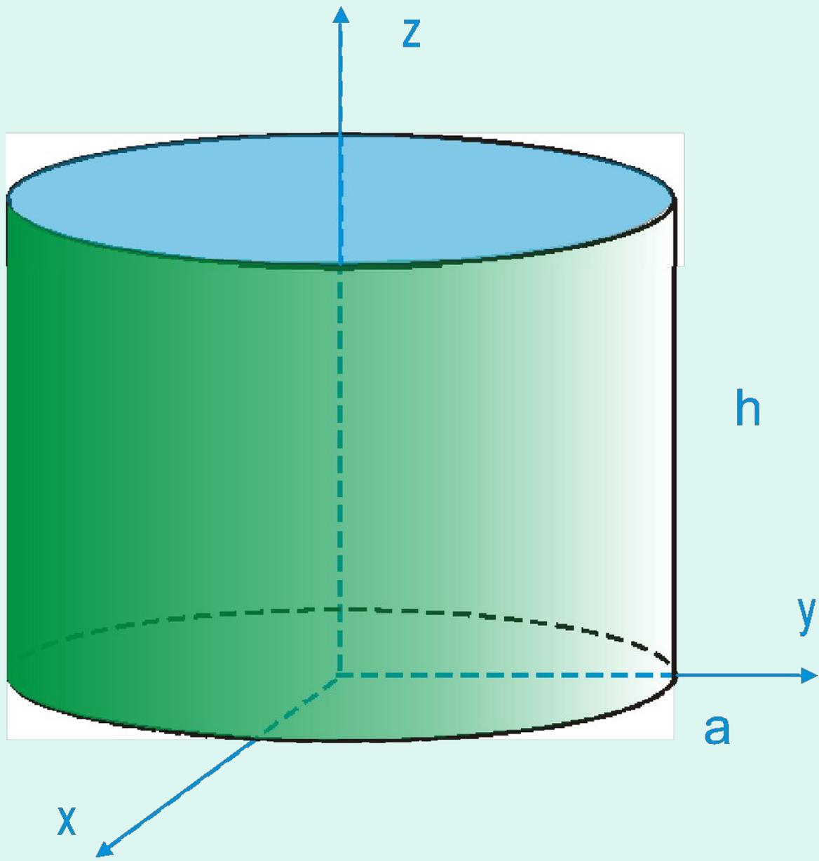
Вычисления проведем в цилиндрических координатах, при этом уравнение цилиндра примет вид  $r = a$
