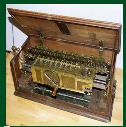
Первая счетная машина, позволявшая производить умножение и деление ( 1673 г.)
