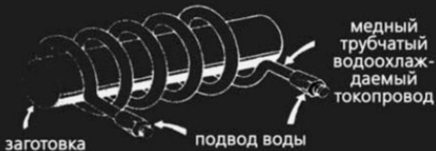
прямоугольная медная трубка со сварными соединениями
