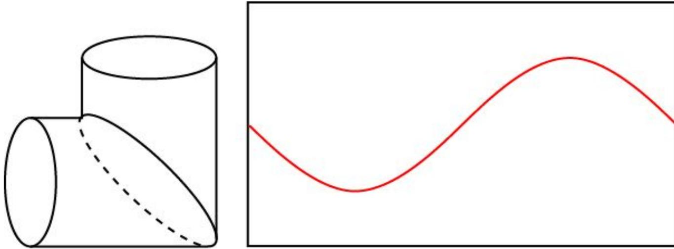
Нужно разрезать лист по синусоиде ( $y = \sin x$ ), и из получившихся кусков сложить две части трубы.
