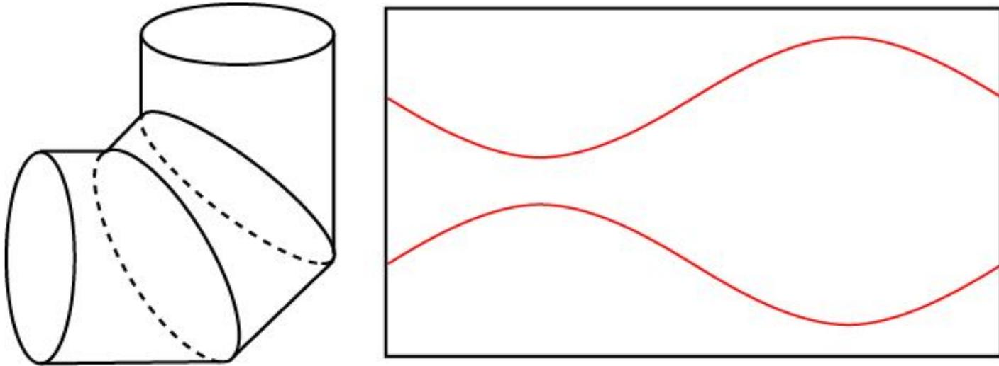
Нужно разрезать лист по двум синусоидам ( $y = k \cdot \sin x$ ,  $y = -k \cdot \sin x$ ,  $k = \operatorname{tg} 22^\circ 30'$ ), и из получившихся кусков сложить три части трубы.
