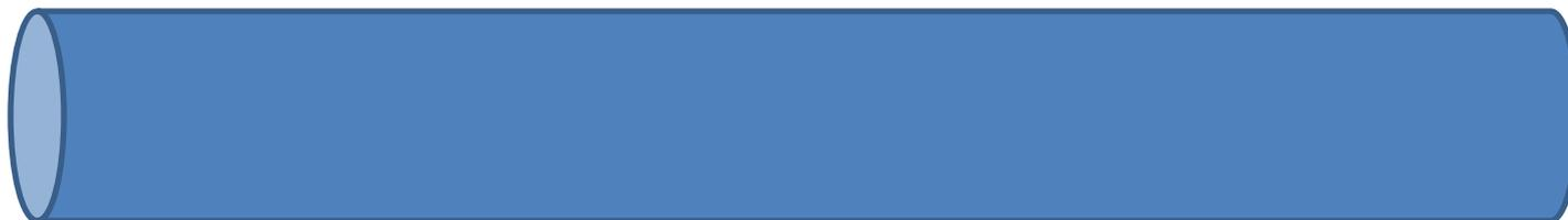
Труба в данном случае цилиндрическая, поверхность трубы - это боковая поверхность цилиндра, развертка которой является прямоугольником
