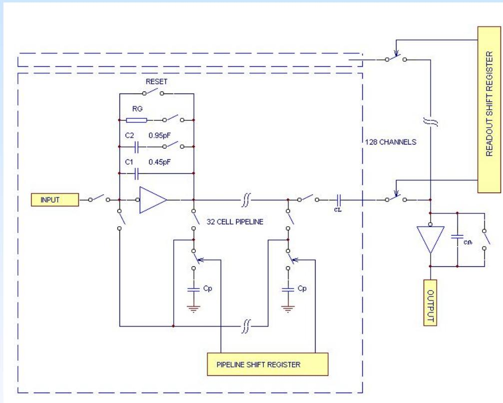
Специализированная микросхема APC128 – пример матрицы из 4096 емкостей.
