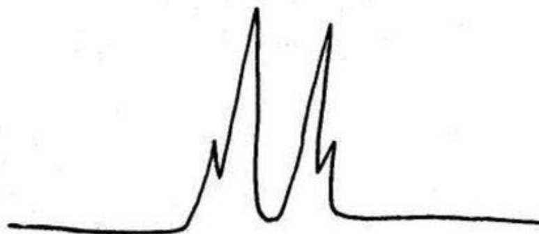
Симметричный квадруплет в ПМР-спектре п-замещенных производных бензола
