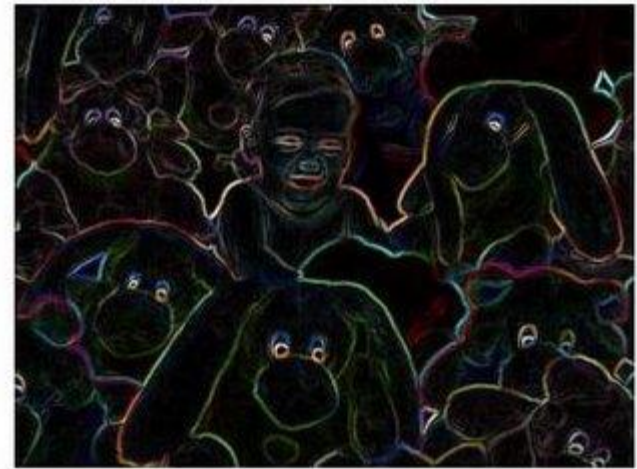
рис.2. Изображение, полученное при использовании матриц Собела, при последовательном применении их к Red, Green и Blue каналам
