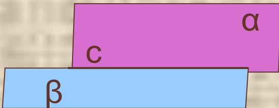
Двугранным углом называют фигуру, образованную двумя полуплоскостями с общей ограничивающей прямой.
