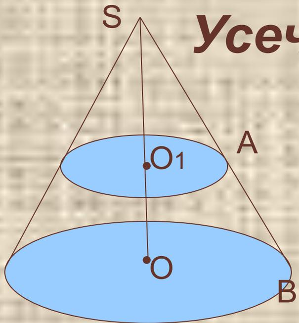
Если в данном конусе проведена плоскость, параллельная его основанию и пересекающая конус, то эта плоскость отсекает от него меньший конус. Оставшуюся часть данного конуса называют **усеченным конусом**.
