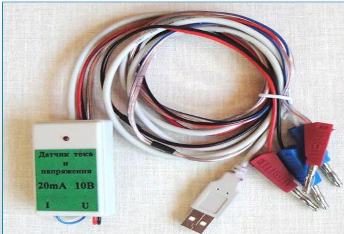
Рисунок 4. Цифровой датчик напряжения на 10V и тока на 20mA
