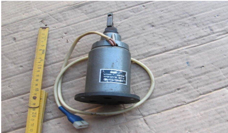
Рисунок 3. Виброгенератор малых частот ЛГШ-402
