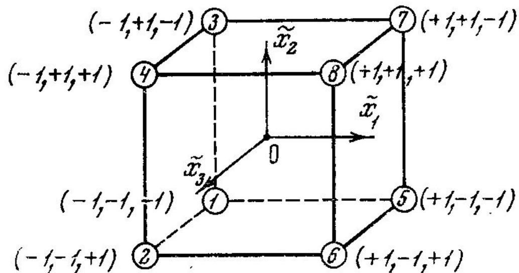
Рис. 5. Геометрическая интерпретация полного факторного эксперимента  $2^3$
