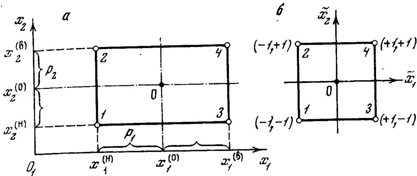
Рис. 4. Геометрическая интерпретация полного факторного эксперимента  $2^2$
