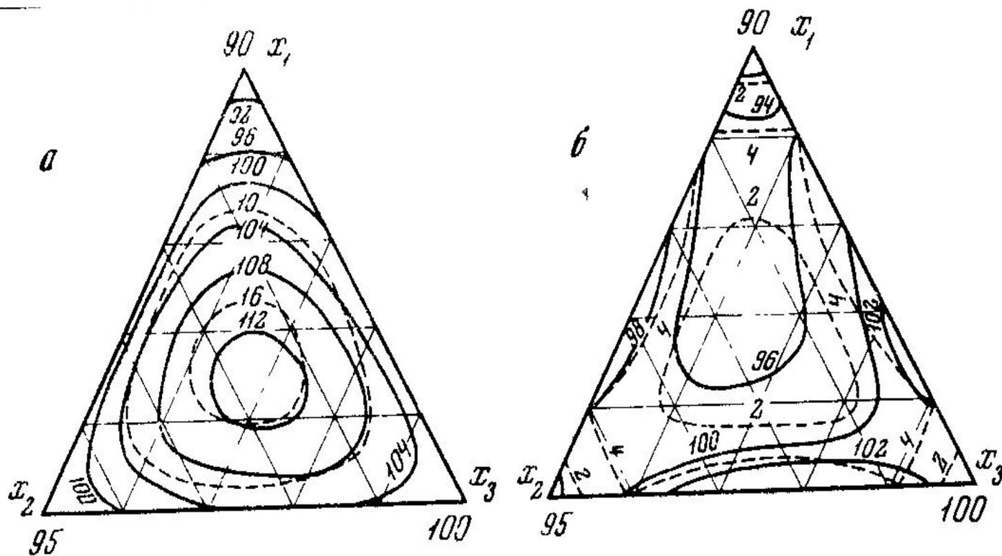
Рис. 30. Контурные кривые поверхностей отклика, описываемых неполными кубическими уравнениями [250]
