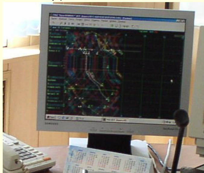
Вид графика исполненного движения (ГИД ВНИИЖТ) на экране дисплея АРМ
