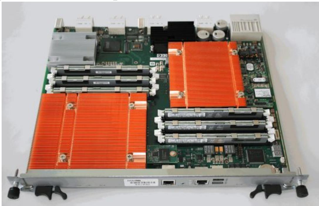
**Процессор:** Два 4-ядерных процессора Intel L5518 CPU 2.13 GHz;
