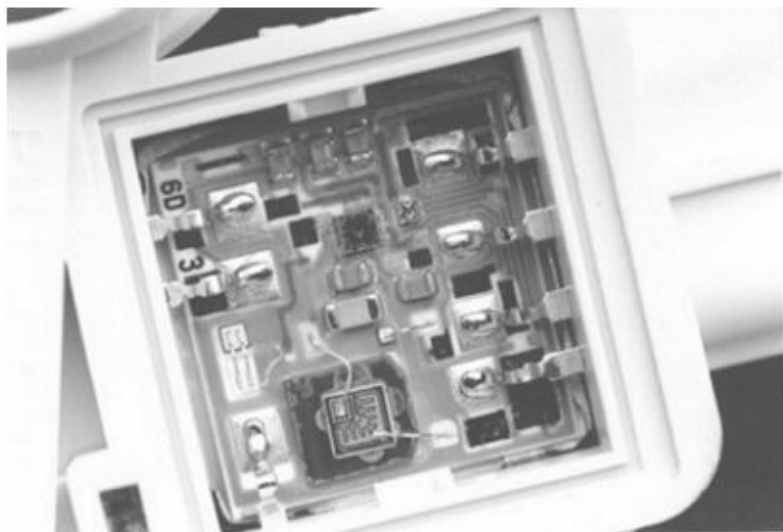
Рисунок 22 – Вид микросхемы с распаянными лазерным паяльником выводами внутри корпуса
