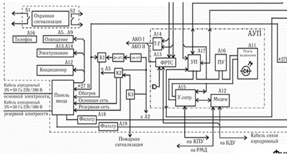
**Аппаратура устройства переключения (УП - А17)** по командам с **ЦП** первого или второго комплектов АКО или по командам с **ПУ** включает или отключает вторичные источники питания АФСМ, АМУ и АКО, а также управляет стабилизатором тока заряда и подзаряда АБ.
