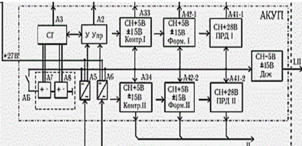
Напряжение 70 В 1 А используется для формирования в стабилизаторе тока (СТ - А3) тока заряда АБ, напряжение 48 В 10 мА — для работы схемы контроля сети в устройстве управления (УУпр - А2), напряжение 27 В 0,6 А — для срабатывания контакторов включения-выключения сервисной аппаратуры.
