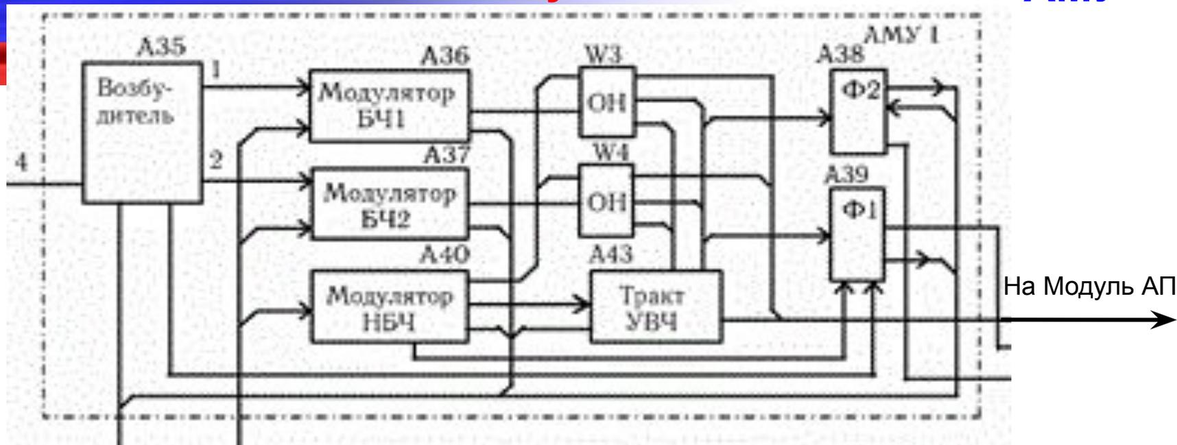
Кроме модуляции в модуляторах осуществляется усиление сигналов с 6... 10 мВт до 5... 15 Вт.
