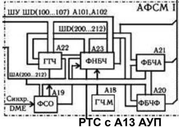
Формирование управляющего напряжения для модуляторов происходит в аппаратуре АФСМ: для **М НБЧ** в **формирователе НБЧ (ФНБЧ)**, для **М БЧ1** и **М БЧ2** — в **формирователе БЧА (ФБЧА)**.
