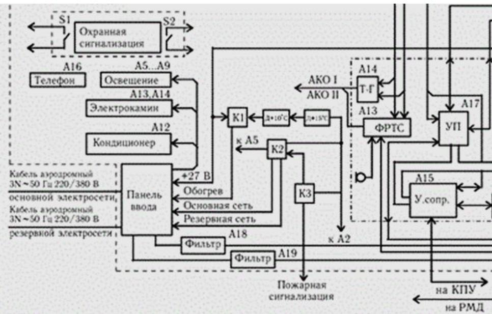
Вся аппаратура радиомаяка, за исключением передающей и контрольной антенн, размещена в шкафу РМА, который устанавливается в аппаратной.
