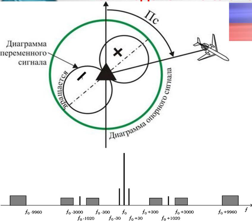
Формирование в пространстве зоны действия РМА, содержащей информацию об азимуте, осуществляется с помощью антенной системы, имеющей три диаграммы направленности: **одну круговую (всенаправленную) для сигнала опорной фазы** и **две развернутые в горизонтальной плоскости на 90 град «восьмерочных» (типа синус-косинус) ДН для сигнала переменной фазы.**
