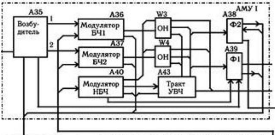
Амплитудная модуляция ВЧ несущей сигналом опорной фазы осуществляется в **модуляторе НБЧ**.
