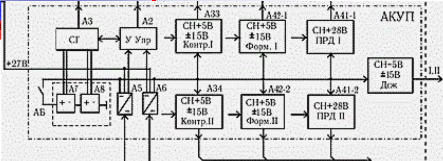
Электропитание РМА осуществляется от аэродромной трехфазной сети переменного тока частотой 50 Гц  $\pm 1\%$  напряжением 380 В  $\pm 10\%$ .
