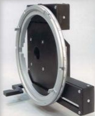
Приставка для измерения пропускания пластин
