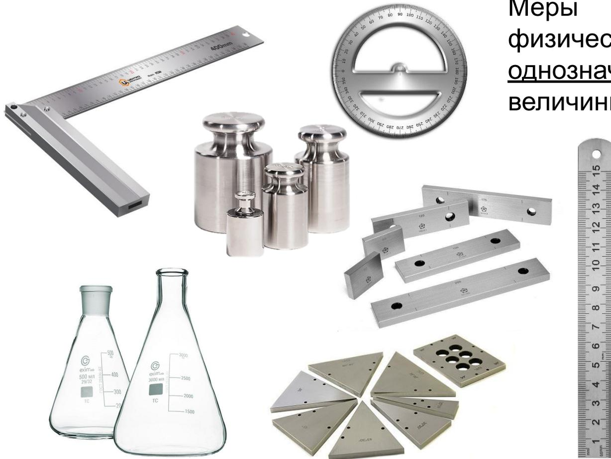
В качестве примеров однозначных мер можно назвать гирю (мера массы), угольник (мера прямого угла), плоскопараллельную концевую меру длины.
