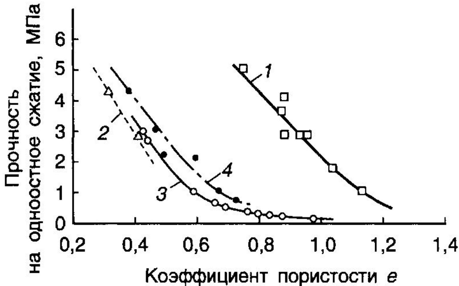
Зависимость прочности на одноосное сжатие глин от коэффициента пористости: 1 – монтмориллонитовая глина, 2 – каолинитовая глина, 3 – гидрослюдистая глина, 4 – полиминеральная, преимущественно гидрослюдистая морская глина (Грунтоведение, 2005)
