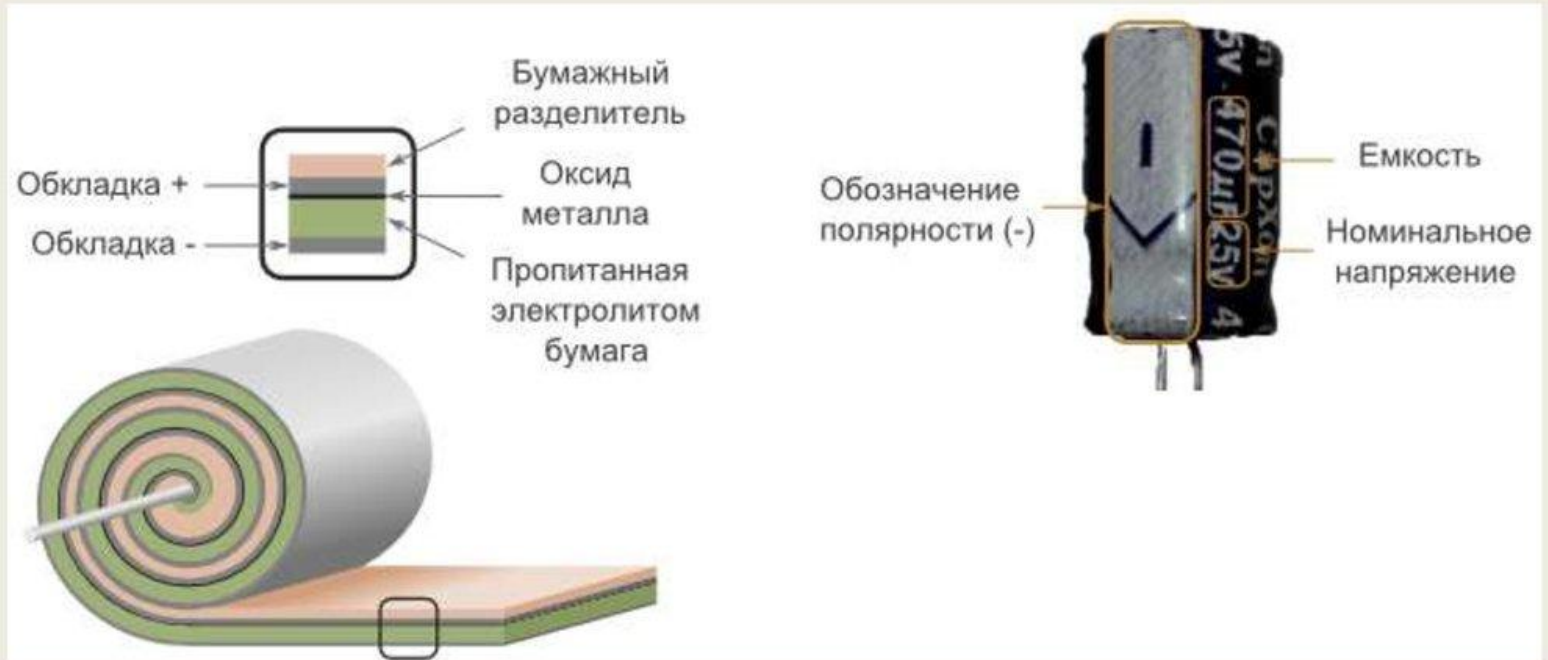
Рис. 12. Рулонная конструкция на примере электролитического конденсатора
