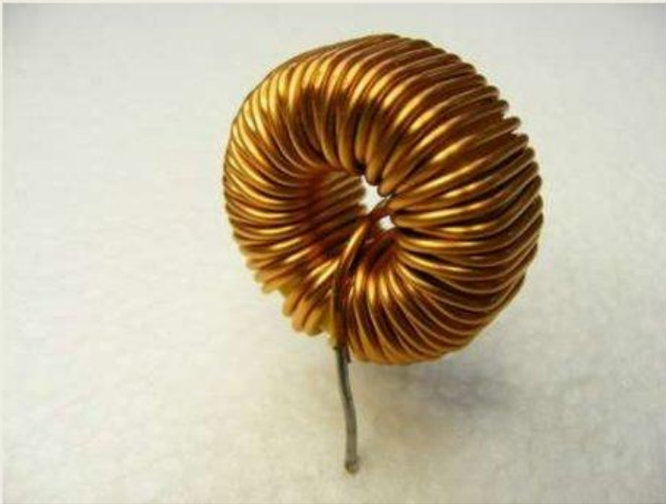
Рис. 17. Тороидальная конструкция индуктивности
