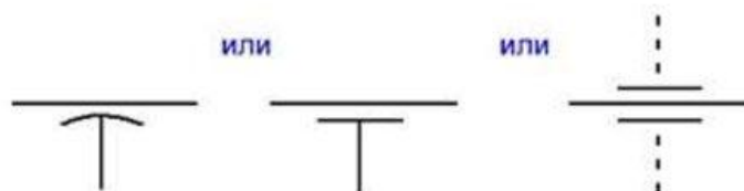
дуга обозначает наружную обкладку (корпус)
