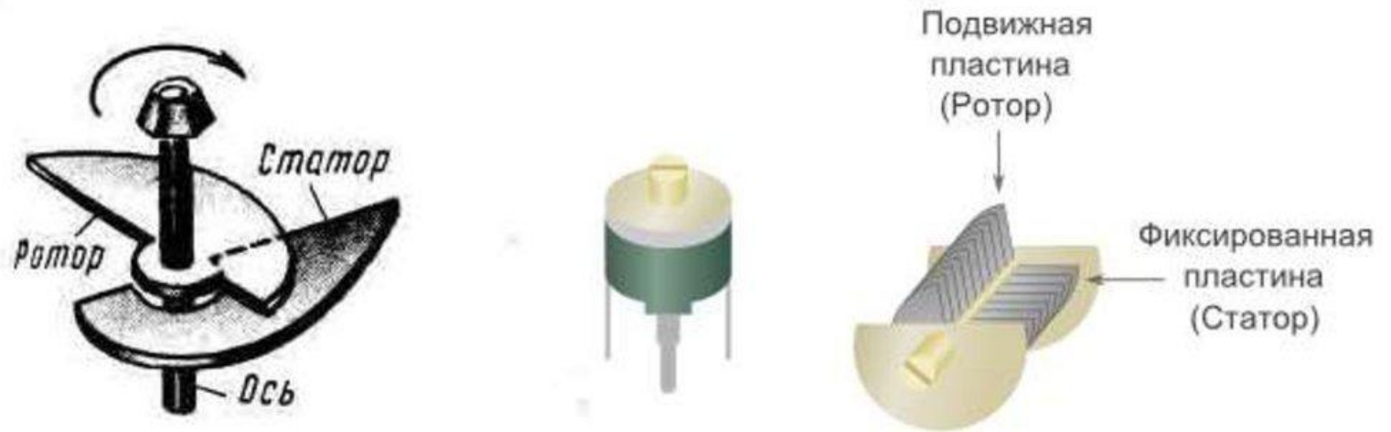
Рис. 13. Конструкция переменного конденсатора
